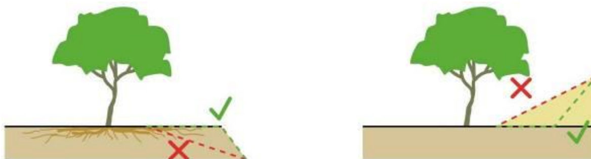
41 pav. Pasirenkant tinkamus techninius sprendinius, formuojant iškasas ir sankasas, galima išsaugoti dalį medžio šaknų
